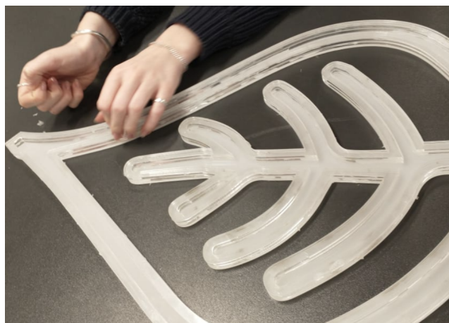
(Prototype skåret i akryl med udhuling til lyset)
