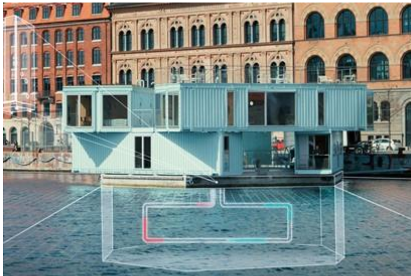
Figur 14. Illustration af varmepumper ”Hydro Source Heating”.
